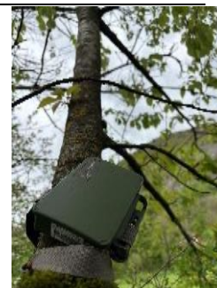
Photo 22 : Boitier enregistreur ultrasons S2, sur le site
